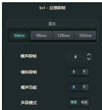
图8.5: 反馈抑制界面
